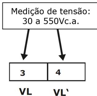
Verifique, utilizando o esquema de ligação adequado, como deve ser feita a ligação das tensões de acordo com o capítulo "**Esquemas de ligação**".
