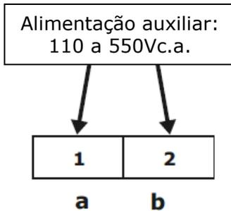
É necessário que a tensão utilizada para a alimentação externa esteja dentro da faixa permitida para o controlador, sob risco de danos, em caso de ligação incorreta ou com tensão acima do permitido.
