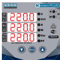
Figura 18 - Exemplo de Leitura de Tensão
