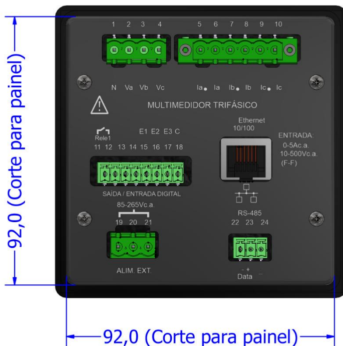
Figura 3 - Corte do painel
