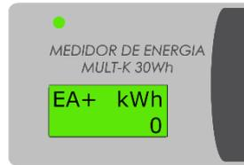
**LED verde:** Sequência de fases positiva na entrada de medição de tensão **(B)**.
