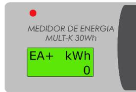
**LED vermelho:** Inversão ou falta de fases na entrada de medição de tensão **(B)**.
