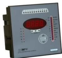
O controlador de fator de potência **KPF-12** é um instrumento que possibilita medição e compensação da energia reativa em instalações elétricas, administrando entrada e saída de até 12 estágios de controle de bancos de capacitores.
