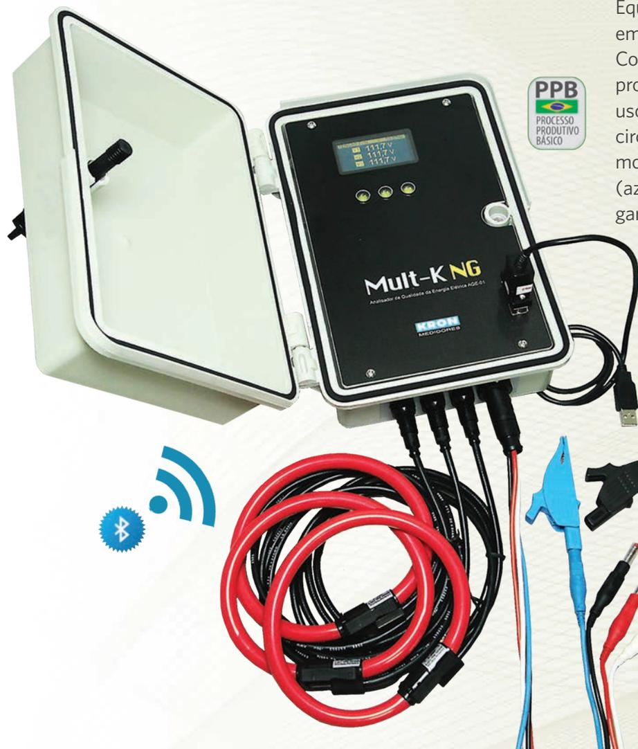
Equipamento para uso portátil e instalação em POSTES, fixação por meio de braçadeiras. Construídos em material isolante, caixa não propagante a chama, grau de proteção IP-65 para uso ao tempo. Utiliza alimentação do próprio circuito de medição. Os sensores de tensão são montados com cabos identificados por cores (azul, branco, vermelho e preto), assim como as garras tipo jacaré-golfinho.
