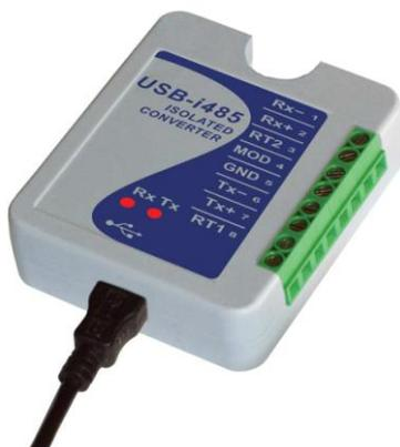
Quando conectado a um PC, é automaticamente detectado e instalado como uma porta COM nativa, compatível com qualquer aplicativo existente de comunicação serial. Auto alimentação de energia (pela porta USB).
