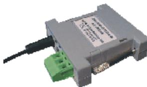
Possui controle automático de velocidade e formato de bits, além de leds para sinalização de transmissão de dados. É necessária uma fonte externa (polarização do sinal DTR) para que o mesmo possa operar com medidores KRON. Detalhes são discutidos no documento “*Procedimento para uso de instrumentos KRON com conversor NOVUS*”.
