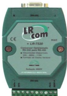
Possui controle automático de velocidade e formato de bits. Conexão de alimentação externa e dados também são feitas por borneira PHOENIX.
